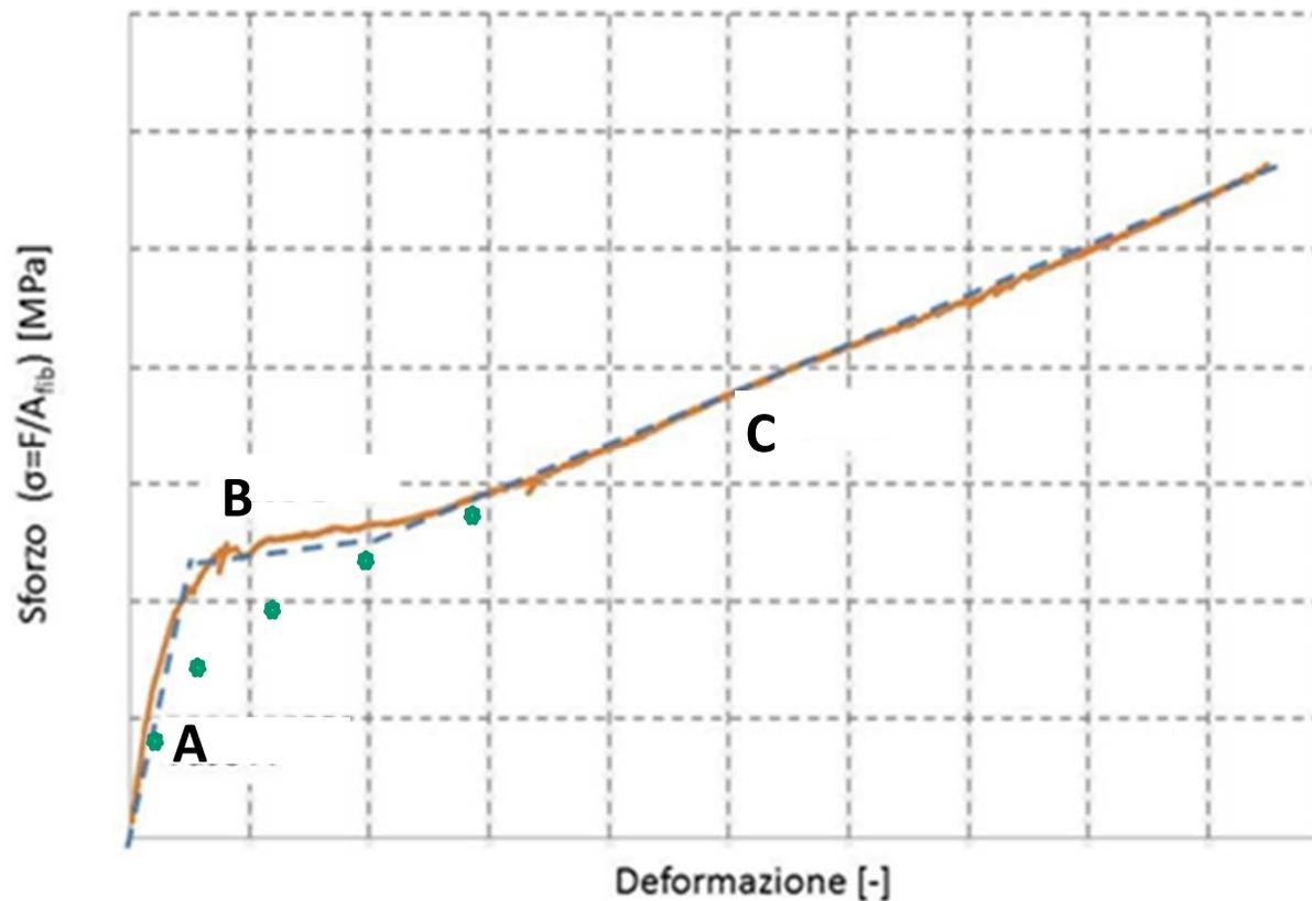
Tale legame non è sufficiente a caratterizzare il comportamento meccanico di un sistema *FRCM*, in quanto l'impiego di quest'ultimo come rinforzo di un elemento strutturale porta a dover considerare i molteplici meccanismi di crisi che possono verificarsi in seguito all'interazione substrato-sistema di rinforzo *FRCM*. Essi sono descritti nella Linea Guida.
