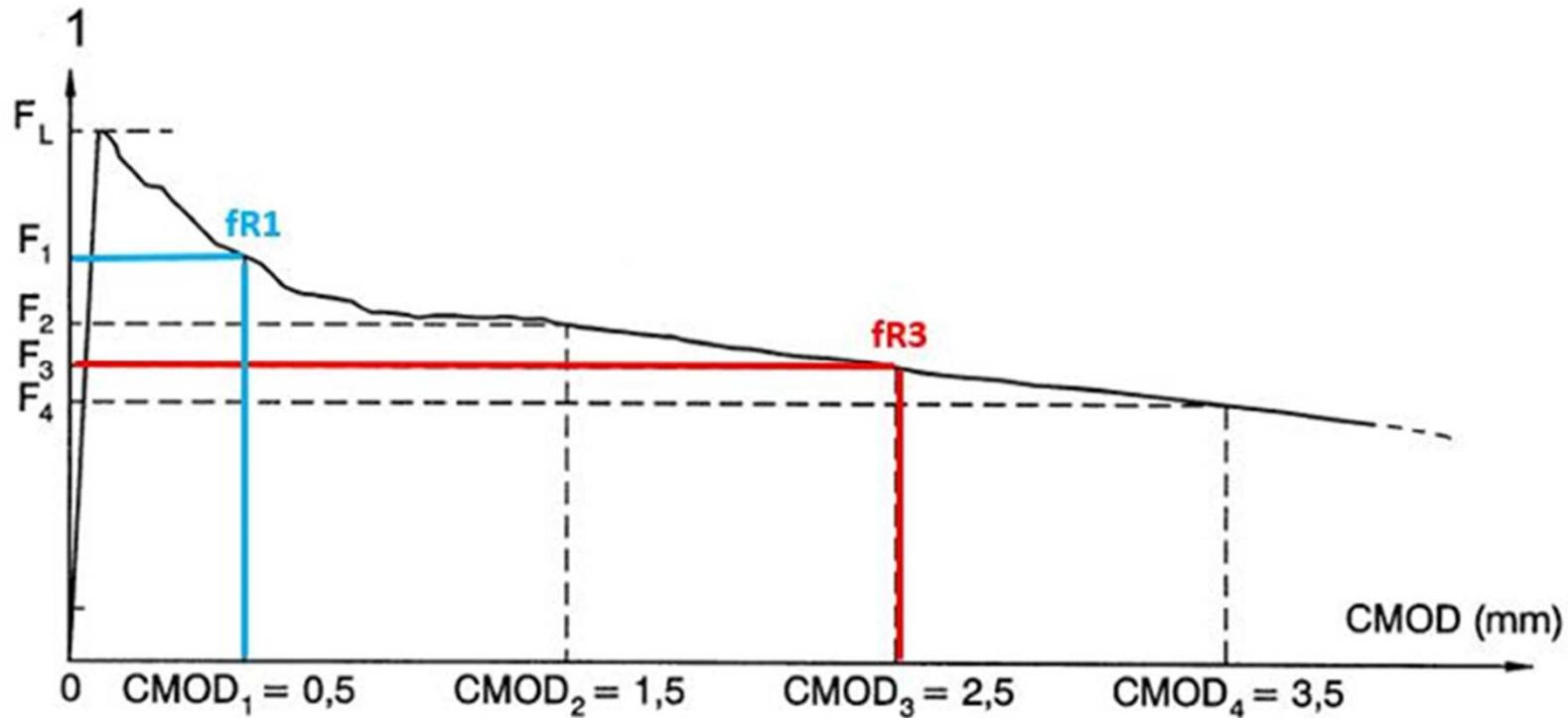
Con riferimento alla singola prova, devono essere determinati: il limite di proporzionalità ( $f_{ct,L}^f$ ) e la resistenza residua per valori di CMOD pari a 0.5 mm ( $f_{R,1}$ ) e a 2.5 mm ( $f_{R,3}$ ).
