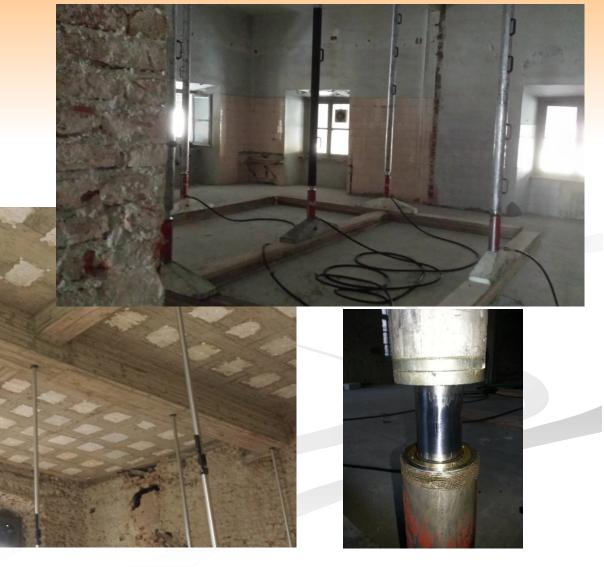
Prove di carico statico con martinetti idraulici a tiro
