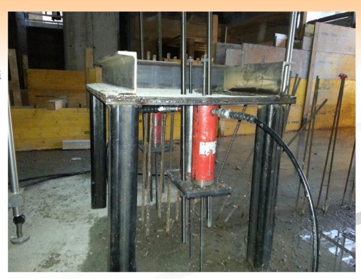
Prove di carico statico con martinetti idraulici a tiro
